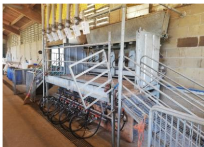
Fig. 2. Impianto a lattodotto
