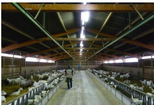
Fig. 4. Esempio di stalla con struttura in muratura e carpenteria in legno per 400 capre in lattazione (foto G. Zanatta)
