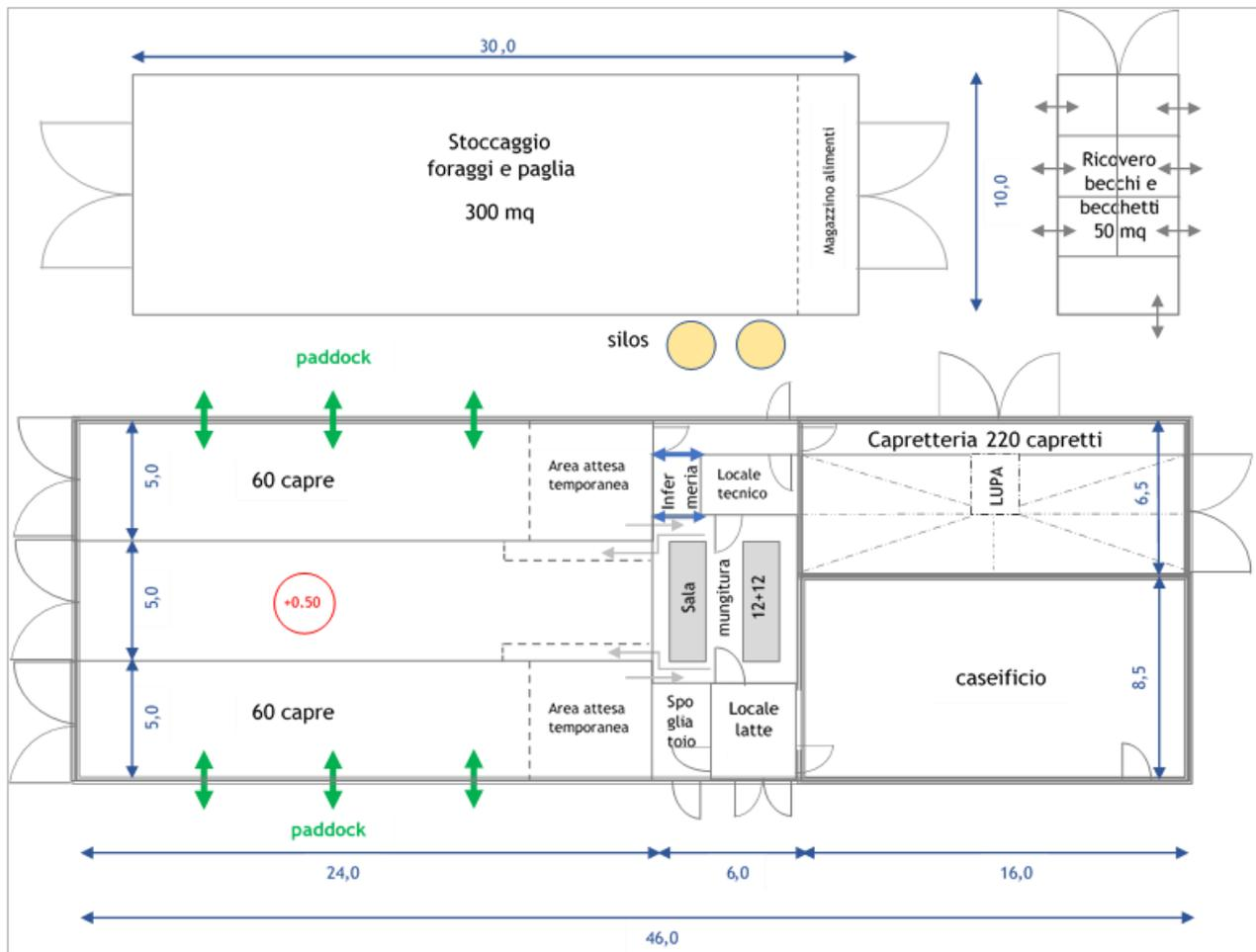
Fig. 2. Esempio di stalla con caseificio per 120 capre in lattazione. Parametri di benessere: superficie lettiera 2,0 m<sup>2</sup>/capo; larghezza fronte alimentazione 0,40 m/capo. Le dimensioni sono espresse in metri
