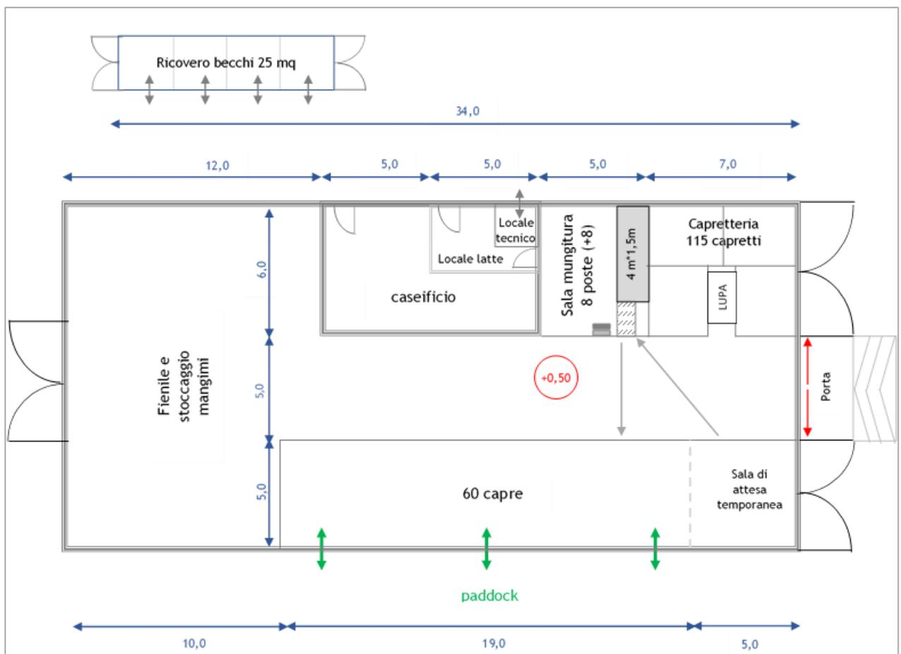
Fig. 1. Esempio di stalla con caseificio per 60 capre in lattazione. Parametri di benessere: superficie lettiera 2,0 m<sup>2</sup>/capo; larghezza fronte alimentazione 0,40 m/capo. Le dimensioni sono espresse in metri
