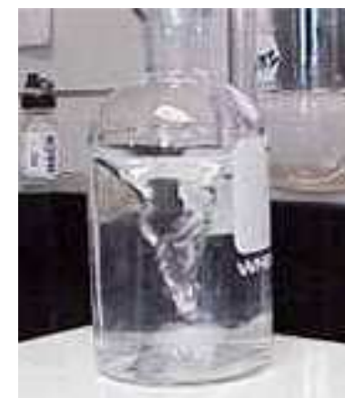
idem, a reazione I_3^- + 2 S_2O_3^{2-} = 3I^- + S_4O_6^{2-} completata
