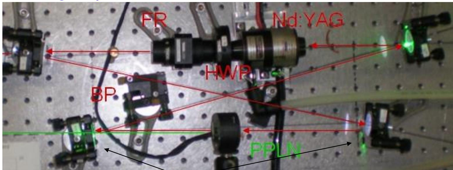
Specchi concavi con  $R=300\text{mm}$  messi a distanza  $2f=R$
