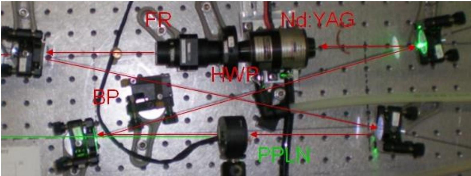
In cavità rimane solo l'onda che viaggia in senso anti-orario e quindi non abbiamo onda stazionaria ovvero non abbiamo spatial-hole-buring.
