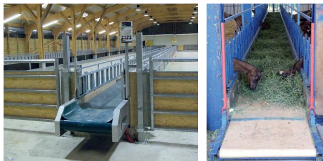
Fig.2. Esempi di nastro per la distribuzione dei foraggi (Fonte catalogo Bayle Industries foto a sinistra, catalogo Gabard Système a destra)
