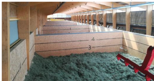
Fig. 2. Celle di essiccaggione e braccio telescopico
