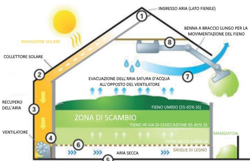
Fig. 1. Esempio di schema impiantistico di fienile ventilato
